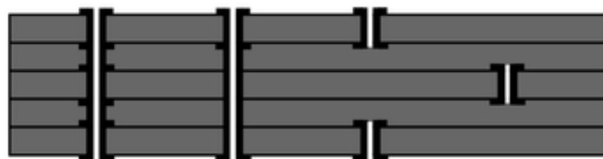
スルーホールビア スルーホールビア 使わない 内層パッドの削除 ブラインドビア ベリッドビア
